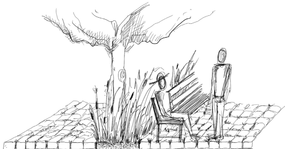
OCELOVÁ OBRUBA V ÚROVNI TERÉNU MEZI DLAŽBOU S VELKOU SPÁROU A ZÁHONEM
